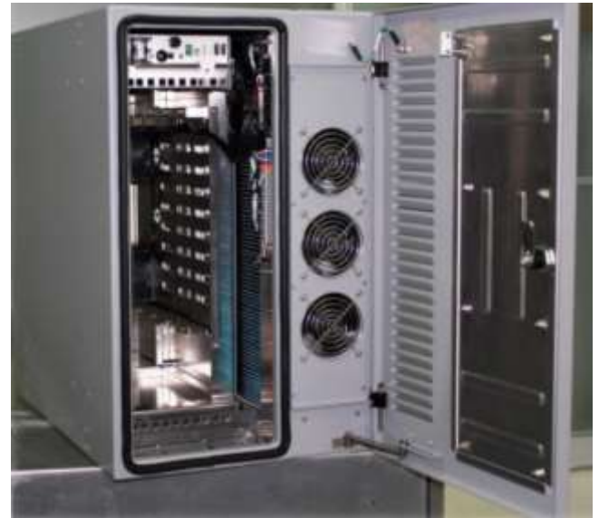
Kuva 1. Tukiasemakabinettiyksikkö, joka sisältää erilaisia integroituja laitteita (3)
