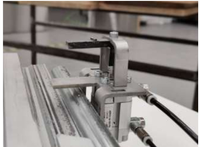
Kuva 1. Protoon valmistettu tarttuja
