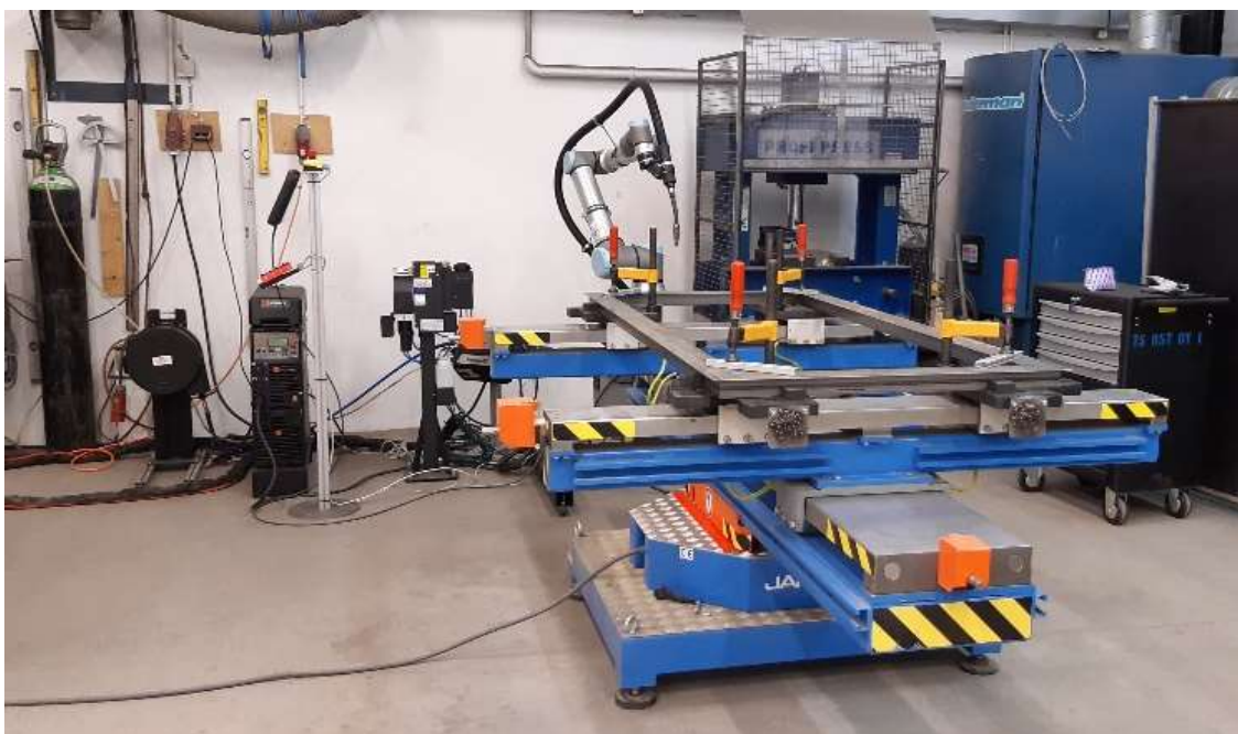
Valmis robottihitsaus solu PP-Fasadi Oy:n tiloissa
